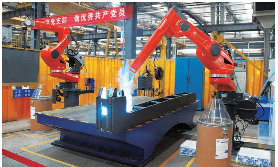
自動焊接機器人
